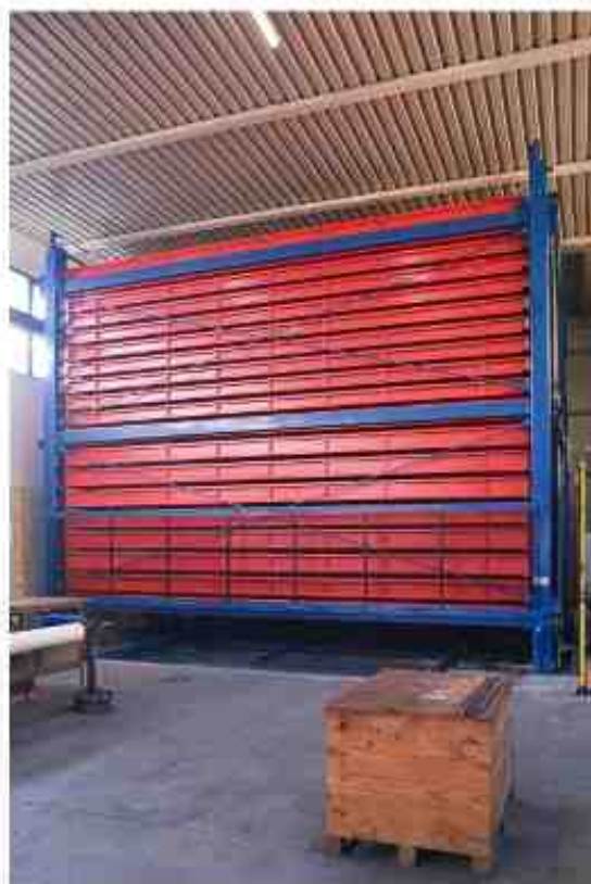
Magazzino automatico a cassette di 7 metri per guide, viti rullate e aste temprate
