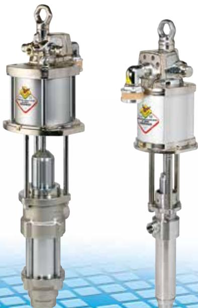
Motore pneumatico e gruppo pompante sono separati in modo che il fluido non possa entrare direttamente a contatto con il corpo motore. Sono indicate per il trasferimento di fluidi industriali e chimici con caratteristiche aggressive. La base del motore è flangiata per permettere l'applicazione delle maniglie, utili per facilitare lo spostamento, e per un agevole fissaggio in varie altre applicazioni.
