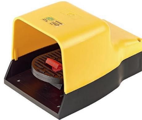
Serie di pedali monostabili e bistabili, a 3 e 5 vie. Standard con protezione antiurto di colore giallo, in resina acetilica, con valvola a spola filettata da 1/4" e dispositivo di sicurezza per evitare eventuali azionamenti impropri.
