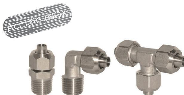
Serie di raccordi a calzamento in acciaio INOX AISI 316 L adatti per applicazioni con temperature molto elevate e/o fluidi aggressivi non compatibili con guarnizioni standard.
