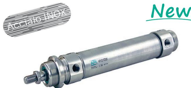
Serie di cilindri in acciaio inox non conformi a normative. Le testate sono unite alla camicia mediante canfrinatura garantendo così una tenuta perfetta. Gli ammortizzi sono in gomma nitrilica per attutire l'urto del pistone. Il tipo RDMAX è dotato di ammortizzi regolabili su entrambe le testate (disponibile solo per alesaggi 32 e 40 mm). Forniti completi di dado stelo. Sui tipi magnetici possono essere applicati uno o più finecorsa magnetici.
