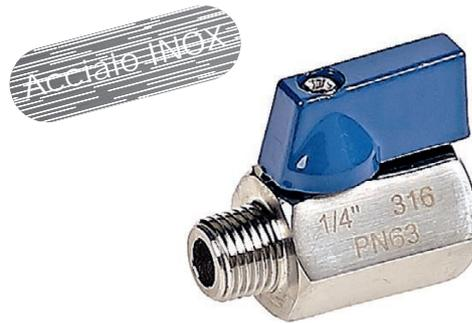
Serie di mini-valvole a sfera, in acciaio inossidabile, ad azionamento manuale, ricavate da barra esagonale. Per montaggio in linea, hanno la funzione di chiudere o aprire il flusso d'aria in entrambe le direzioni. Per impiego nei settori alimentare e chimico.
