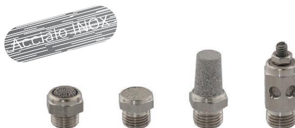
Serie di silenziatori e regolatori di scarico silenziati in acciaio INOX. Da applicare sugli scarichi delle valvole per ridurre il rumore. I regolatori di scarico silenziati, inoltre, regolano la velocità di scarico e quindi la velocità di traslazione dei cilindri.
