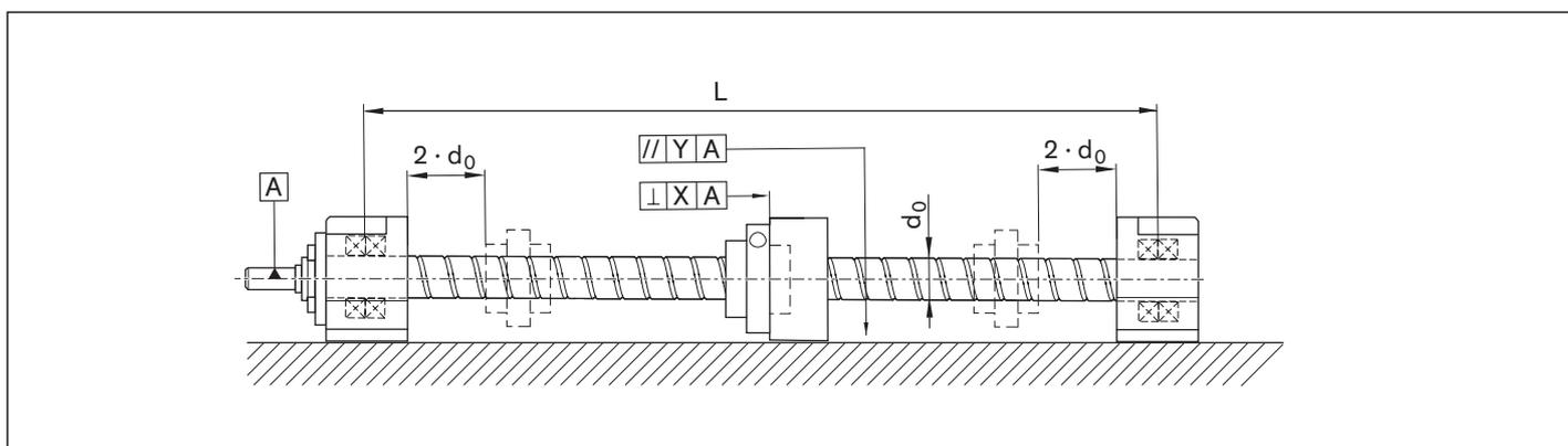
Errore di parallelismo e indicazione dell'ortogonalità fra l'asse della vite e la superficie di contatto del supporto della chiocciola
