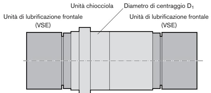
Direzione di montaggio dell'unità di lubrificazione frontale su tipi di chiocciola
