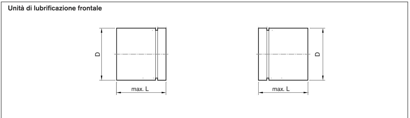
**Avviso:** l'unità di lubrificazione frontale viene fornita completamente montata con la vite a sfere.
