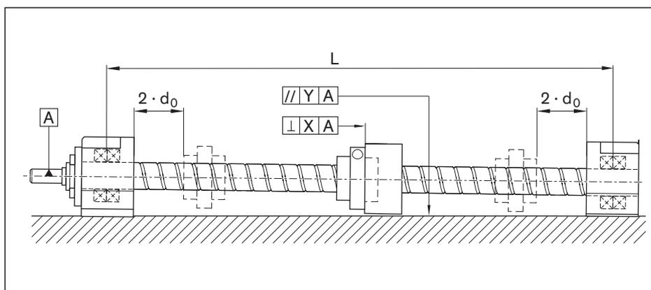
Errore di parallelismo e indicazione dell'ortogonalità fra l'asse della vite e la superficie di contatto del supporto della chiocciola
