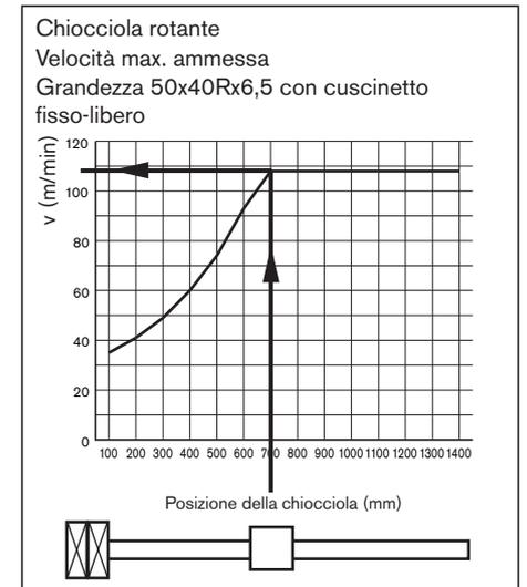
Con la lunghezza massima raccomandata della vite  $L_{Gew\ max}$  nell'esempio del diagramma esterno a destra viene raggiunta, con una posizione della chiocciola di 700 mm, una velocità di 108 m/min.
