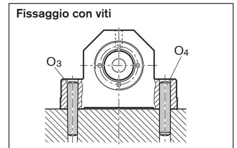
Coppie di serraggio per viti di fissaggio secondo VDI 2230 per  $\mu_G = \mu_K = 0,125$  (coefficiente di attrito)
