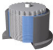
**Abbildung 3.1.2: Formgebung im Gießverfahren mit schraubenförmig gespultem Zugträger**
