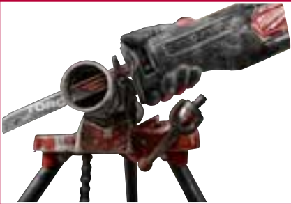
Scarpa orientabile per un uso ottimale durante il taglio
