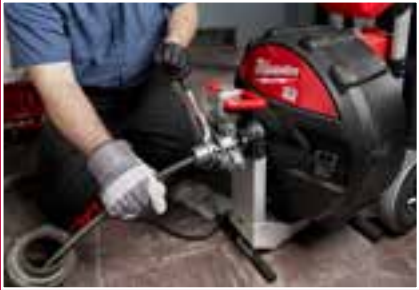
Sistema CABLE DRIVE di alimentazione e ritrazione automatica della spirale
