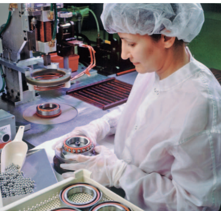
... durante il montaggio dei cuscinetti
