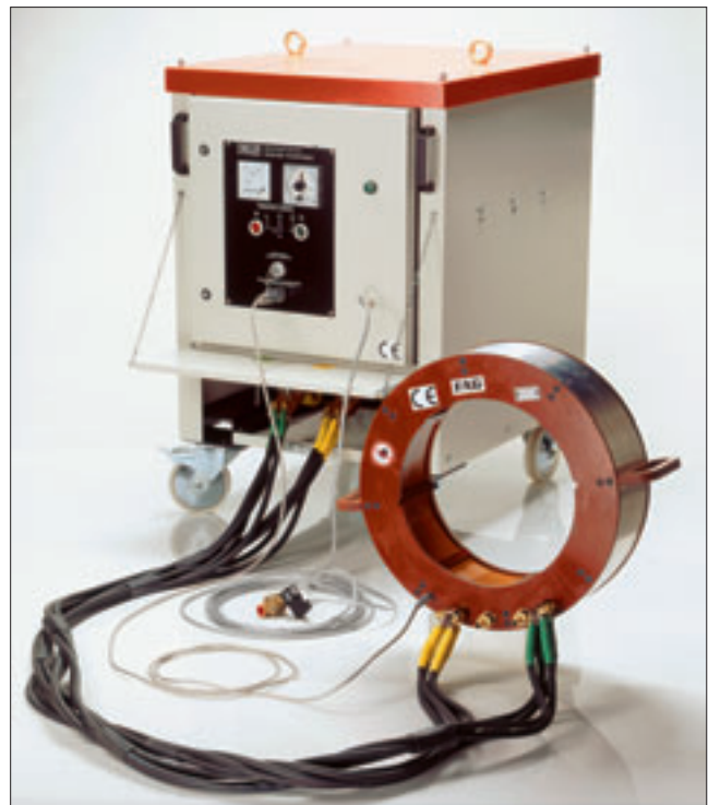
Impianto di riscaldamento a bassa tensione con trasformatore per lo smontaggio di anelli interni di cuscinetti a rulli cilindrici
