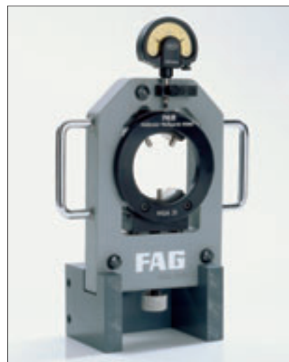
Strumento di misurazione del cerchio d'involuppo rulli FAG MGA 31 per l'impostazione del gioco radiale di cuscinetti a rulli cilindrici con anello esterno estraibile
