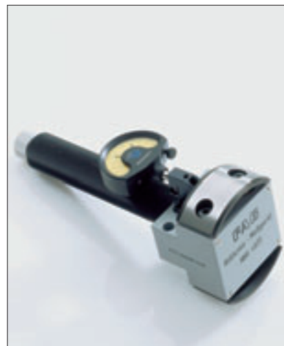
Strumento di misurazione del cerchio d'involuppo rulli FAG MGI 21 per l'impostazione del gioco radiale o del precarico di cuscinetti a rulli cilindrici con anello interno estraibile
