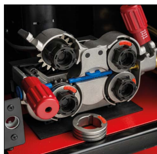
Compatto trainafilo a 4 rulli con sgancio rapido e rulli di inserimento ( \varnothing 37 mm), facilmente identificabile grazie a un sistema di codice colore che fa riferimento ai diametri
