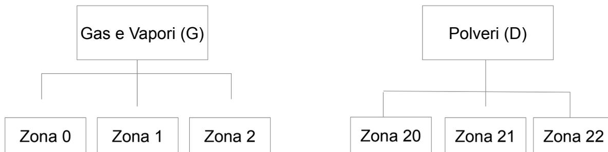
Con la **Direttiva Atex 99/92/CE** (Per la sicurezza dei lavoratori) sono indicate di impiego in cui i prodotti sottoposti a conformità della direttiva **Atex 94/9/CE** si troveranno a funzionare. Queste sono espresse da “**zone**” e definite secondo il grado di probabilità che si verifichi un'atmosfera potenzialmente esplosiva rispettivamente per ogni tipo di atmosfera ( miscela gas-aria o miscela polvere-aria)
